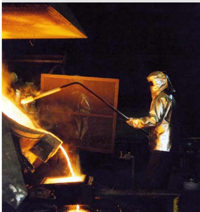
Рис. 1: Традиционный метод измерения температуры жидкого металла с помощью погружного зонда
