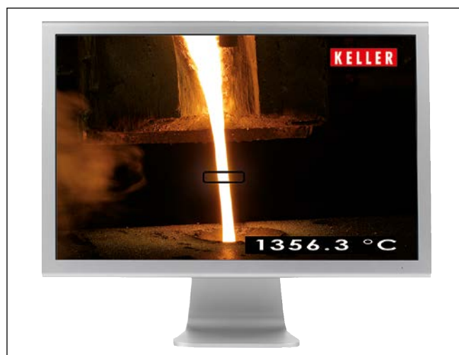
Рис. 8: Видеоизображение с маркировкой поля измерения и отображением температуры
