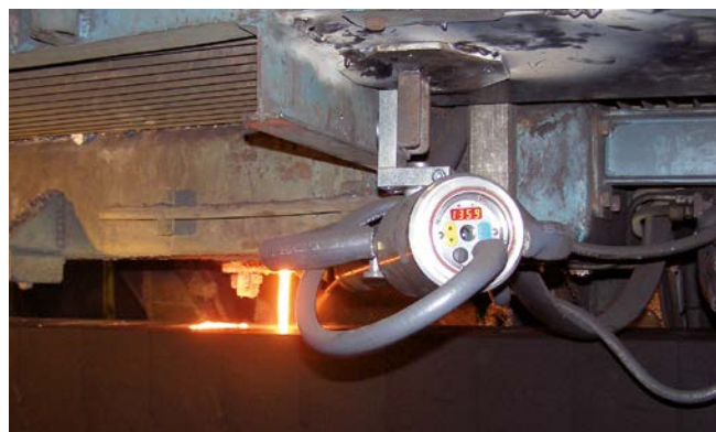
Рис. 5: Оптический метод измерения температуры на разливочных автоматах
