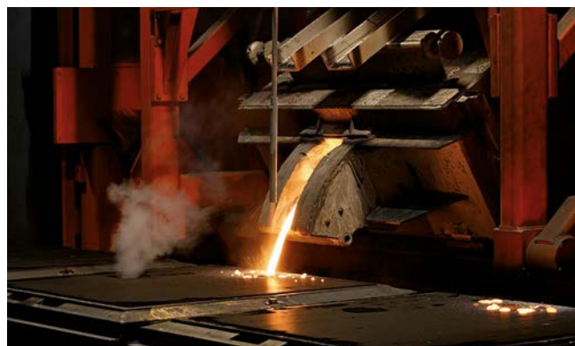
Рис. 6: в зависимости от угла наклона ковша изменяется позиция струи жидкого металла
