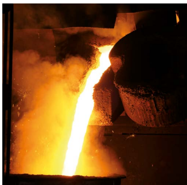
Рис. 4: Переливка металла из печи в ковш
