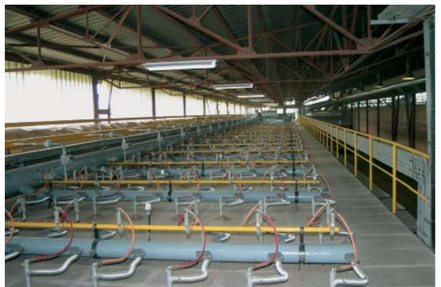
**Bild 6: Tunnelofen mit neuer Deckenbrenneranlage**
