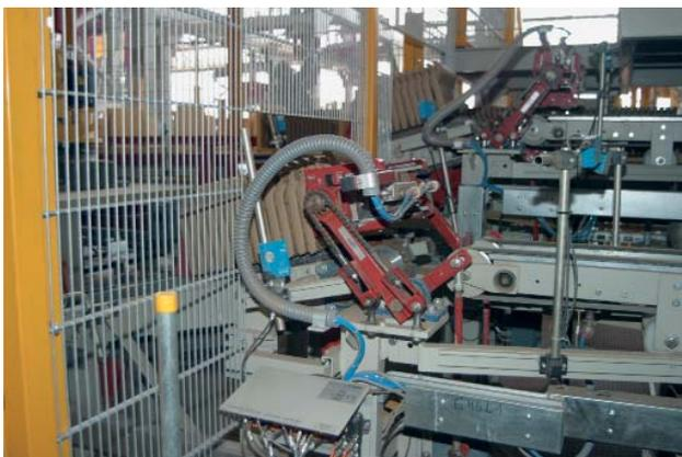
**Bild 5: Aufstellvorrichtung zum Bilden von U-Kassetten-Paketen**
