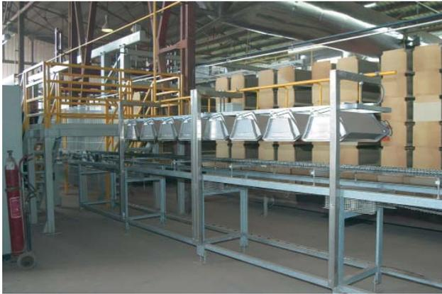
**Bild 3: Trockenstrecke mit gasbetriebenen Heizstrahlern**
