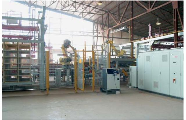
**Bild 4: U-Kassetten-Setzanlage mit einem Roboter**
