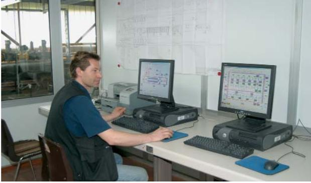
**Bild 11: Prozessrechner für die Steuerung und Bedienung der Trocken- und Ofenanlage**
