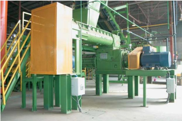
**Bild 1: Neuer Extruder für die Batzenherstellung**
