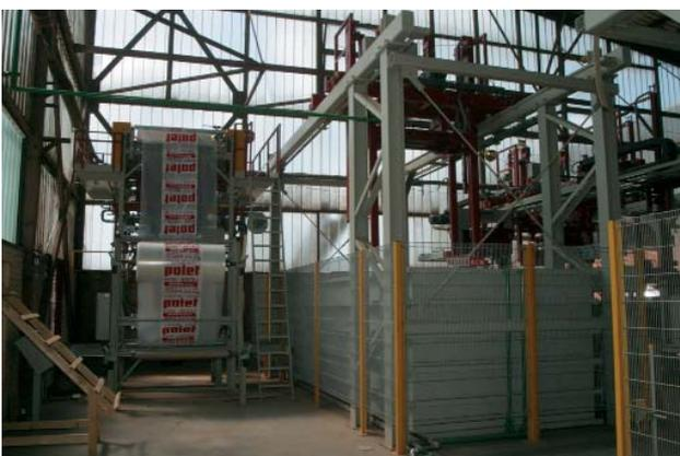
**Bild 9: Tauchanlage für Versandpakete und Folienhaubenautomaten**
