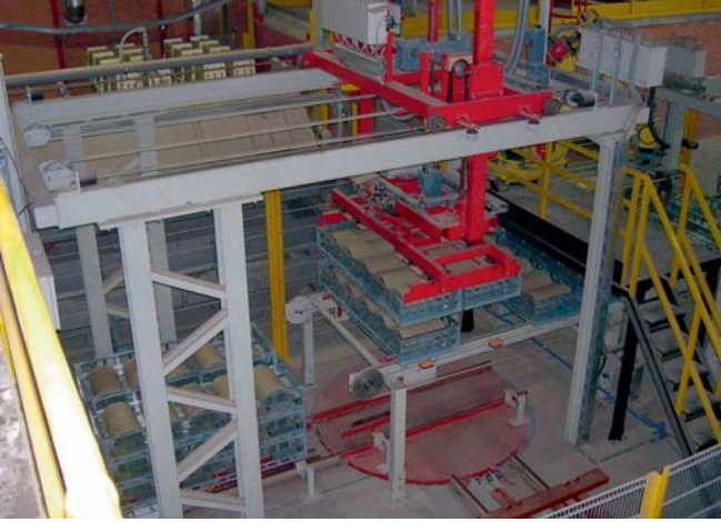
Übersetzeinrichtungen stapeln und entstapeln die Schichten des Trocknerwagens Stacking and de-hacking of layers of dryer cars by means of transfer devices
