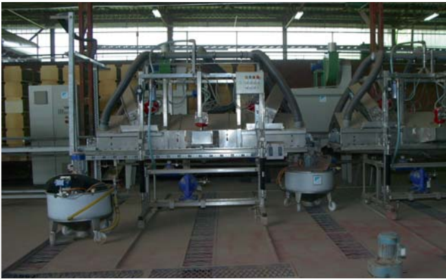
Verfahrbare Engobierkabinen Movable engobing cabin
