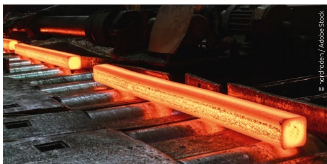
Escala e óxido alteram significativamente as propriedades de radiação
