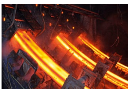
Planta de colada continua
