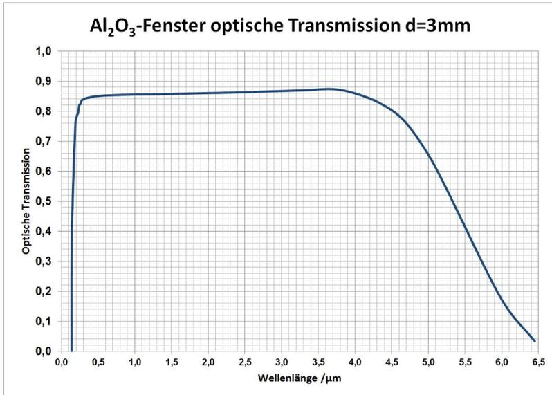
*Die wirksame Transmission hängt von der Wellenlänge des verwendeten Pyrometers ab und die zur korrekten Messung einzustellende Korrektur des Emissionsgrades ist aus der Bedienungsanleitung zu entnehmen!*
