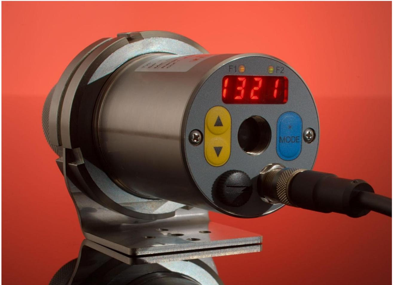
Para a medição de temperatura sem contacto do fluxo de vazamento de metal líquido nas linhas de lingotamento contínuo.
