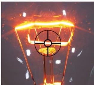
A marcação do campo de medição no visor indica a posição exata e o tamanho do campo de medição. Para objetos de medição muito brilhantes, o filtro de polarização PA 20/P pode ser parafusado sobre o ocular para proteger o olho. Para dispositivos com faixa de medição > 2000 °C, o filtro é integrado como padrão.
