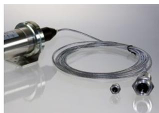
Em um pirômetro de fibra ótica, a ótica e a eletrônica estão separadas uma da outra. Uma fibra ótica transmite a radiação infravermelha da cabeça de medição para a eletrônica. A cabeça de medição pode ser usada em temperaturas ambientes de até 250 °C sem refrigeração.
