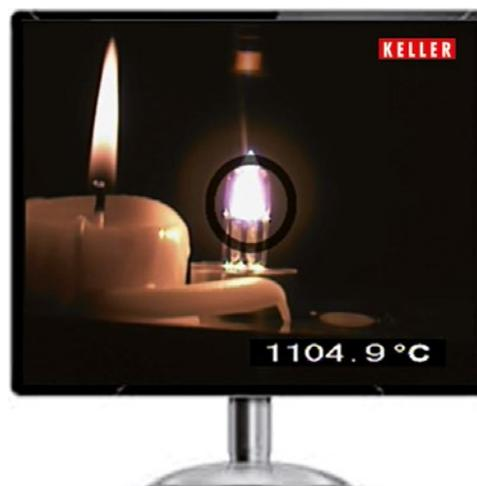
Grazie al controllo automatico dell'esposizione con funzione TBC, il campo di misura è sempre illuminato in modo ottimale. L'immagine mostra la marcatura del campo di misura e il valore di misura.
