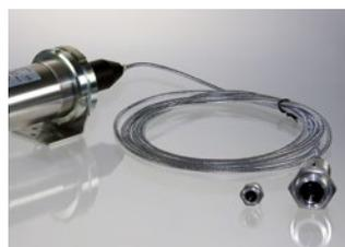
In un pirometro a fibra ottica, l'ottica e l'elettronica sono separate l'una dall'altra. Una fibra ottica trasmette la radiazione infrarossa dalla testa di misura all'elettronica. La testa di misura può essere utilizzata a temperature ambiente fino a 250 °C senza raffreddamento.
