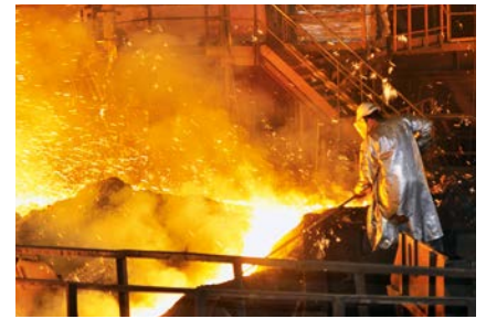
Canal de fundição
