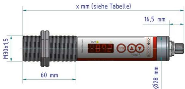
Comprimentos dos termômetros infravermelhos compactos
