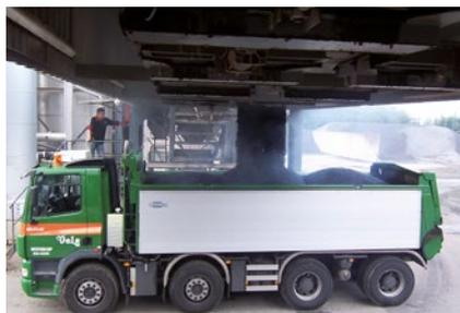
Usina de mistura asfáltica / concreto
