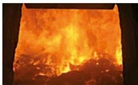
O CellaPort PT 113 foi especialmente desenvolvido para a medição de temperatura em fornos aquecidos por chama. Devido à faixa espectral seletiva de 3,9  $\mu\text{m}$ , o vapor de água e o CO<sub>2</sub> no campo de visão do pirômetro não têm influência sobre o resultado
