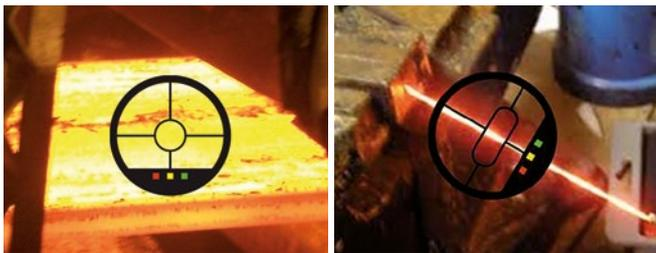
Para uma medição correta, o campo de medição de um pirômetro espectral deve ser totalmente iluminado pelo objeto. Para marcar o tamanho e a posição exata, uma marca de campo de medição é refletida na visão através da lente. Em instrumentos com um campo de medição retangular, uma marcação retangular é incorporada. Com um pirômetro de proporção, o campo de medição pode ser menor do que o objeto. Isto torna possível medir fios finos.
