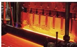
O vidro é transparente na faixa espectral visível e na faixa infravermelha próxima. A emissividade depende da temperatura, do comprimento de onda, do tipo de vidro e da espessura do vidro. Na faixa entre 4,6 - 4,9  $\mu\text{m}$ , o vidro tem uma emissividade de quase
