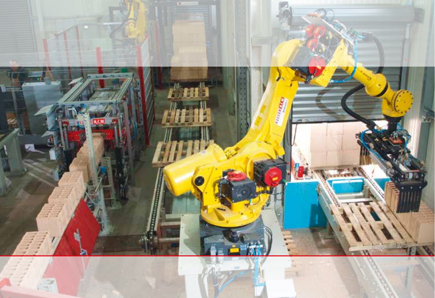
Ein Hochleistungs-Industrieroboter entstapelt, vereinzelt und gruppiert die Ziegel A high-performance industrial robot de-hacks, separates and groups the bricks
