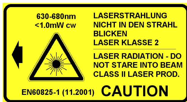
Abbildung 1: Am Pyrometer angebrachtes Laserwarnschild
