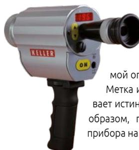
Для быстрых контрольных измерений используются портативные пирометры серии PT CellaPort. Приборы оснащены сквозным видоискателем с фокусируемой оптической системой резкого изображения. Метка измеряемого пятна в видоискателе указывает истинное место измерения пирометра и, таким образом, позволяет выполнять точное наведение прибора на точку измерения через отверстие в печи.
