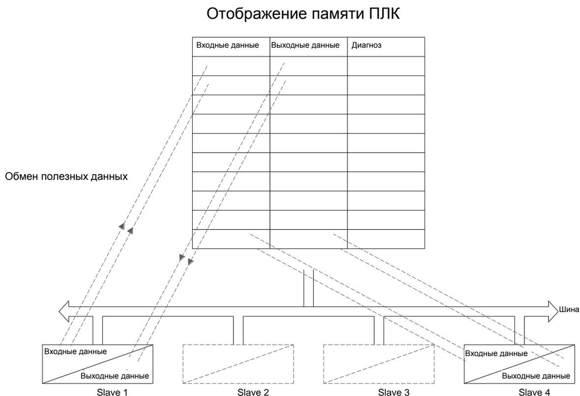
Схема 5.1 Profibus Обмен данными между ведущими (Master) и ведомыми (Slave) станциями.
