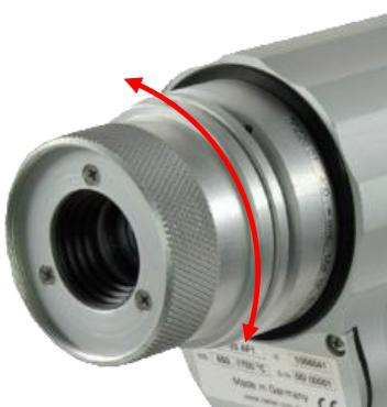
Пирометр оснащён фокусируемой оптикой. Для правильного фокусирования пирометра на объект измерения следует настроить объектив таким образом, чтобы объект измерения и маркировка поля зрения (в сквозном видоискателе) были одновременно отчётливо видны.
