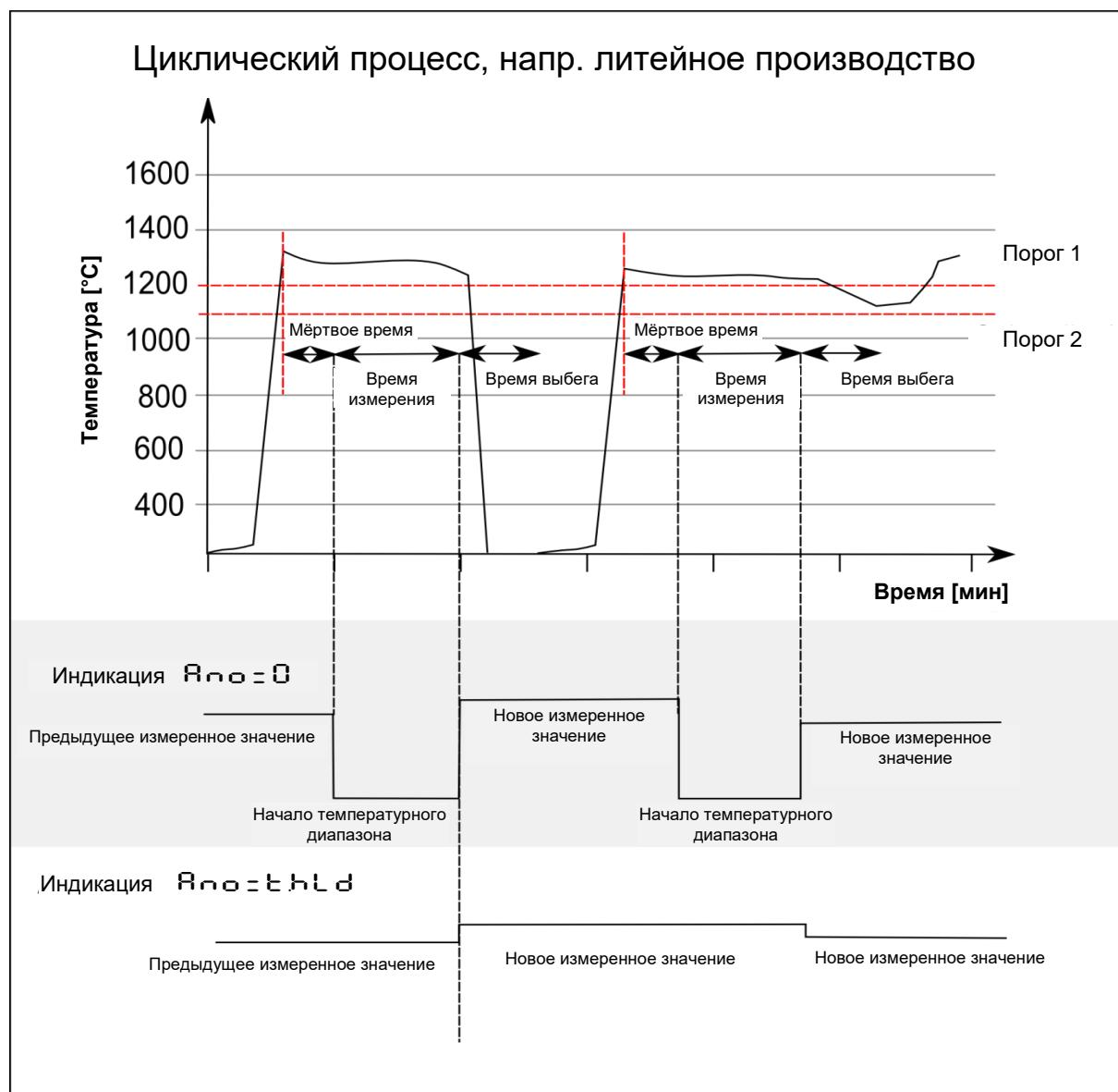
**Порог для синхронизации измерительного цикла**
