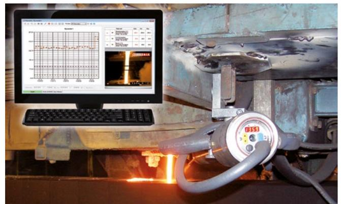
**Fig. 4** Punto de medición en la máquina de colada automática y monitor para visualizar la temperatura de colada y la imagen de vídeo.
