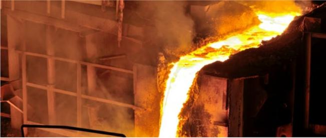
**Fig. 3** Canal de fundición como punto de medición, con escoria y óxidos en la masa fundida fluida.
