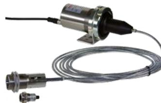
El espacio limitado para la instalación o las altas temperaturas ambientales pueden requerir un cabezal de sensor óptico separado y un cable de fibra óptica para la transmisión de la radiación infrarroja a la unidad de evaluación. El cabezal puede utilizarse sin dispositivo de refrigeración hasta temperaturas ambiente de 250 °C.
