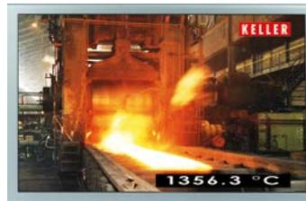
Para el ajuste óptico, puede elegir entre diferentes opciones de visión del CellaTemp PA 40: con mirilla a través de la lente, con puntero láser o con cámara en color. El marcador en el visor o en la pantalla, definen el tamaño y la posición exactos de la zona de medición.
