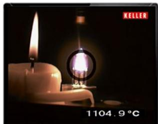
Grazie al controllo automatico dell'esposizione con funzione TBC, il campo di misura è sempre illuminato in modo ottimale. L'immagine mostra la marcatura del campo di misura e il valore di misura.
