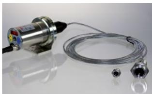
In un pirometro a fibra ottica, l'ottica e l'elettronica sono separate l'una dall'altra. Una fibra ottica trasmette la radiazione infrarossa dalla testa di misura all'elettronica. La testa di misura può essere utilizzata a temperature ambiente fino a 250 °C senza raffreddamento.
