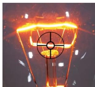
Il contrassegno del campo di misura nel mirino indica l'esatta posizione e dimensione del campo di misura. Per oggetti da misurare molto luminosi, il filtro di polarizzazione PA 20/P può essere avvitato all'oculare per proteggere l'occhio. Per dispositivi con range di misura > 2000 °C, il filtro è integrato di serie.
