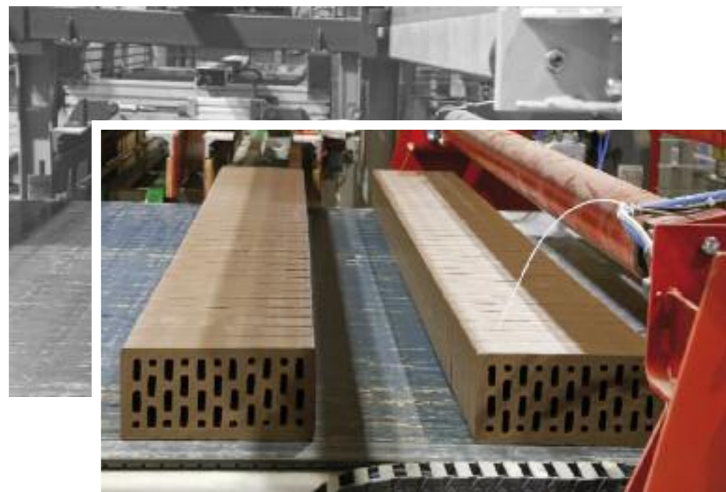
Detailansicht des Durchhubabschneiders mit Anfasvorrichtung
