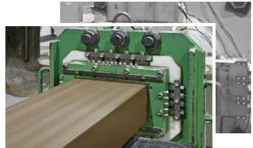
Tonstrangaustritt aus dem Mundstück
