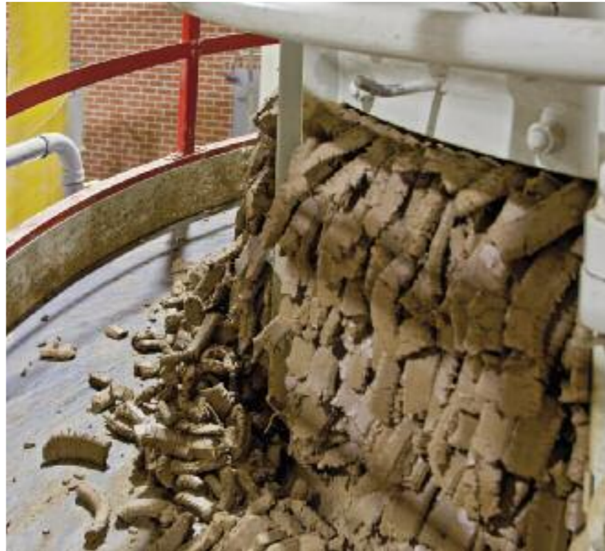
Materialaustritt auf den Sammeltrichter des Siebrundbeschickers
