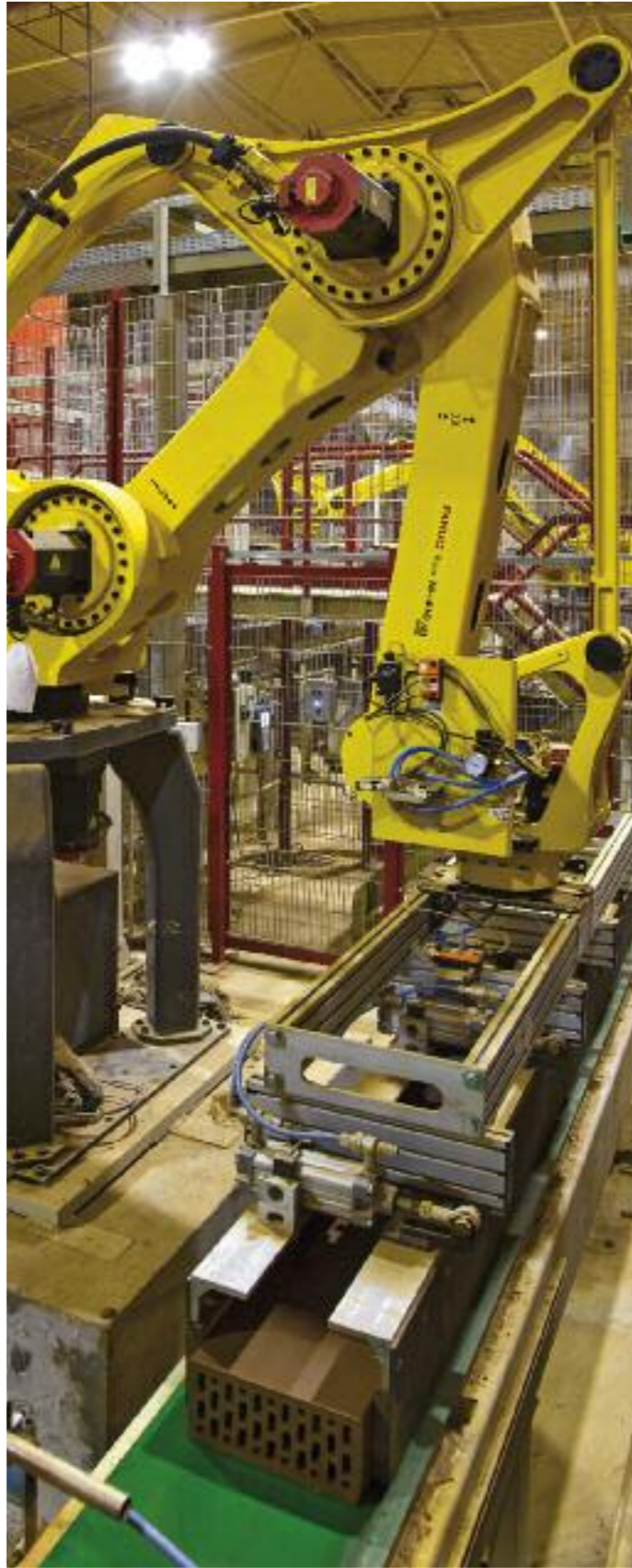
Übersetzroboter mit Batzengreifer
