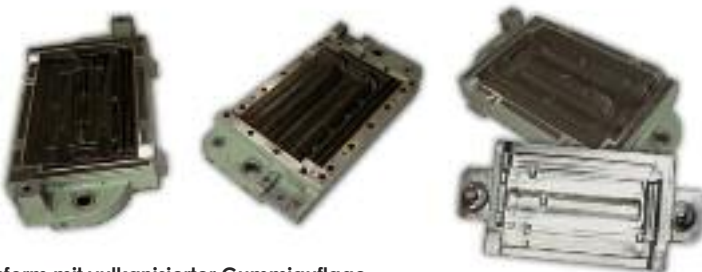
Pressform mit vulkanisierter Gummiauflage Mould with vulcanized rubber covering
