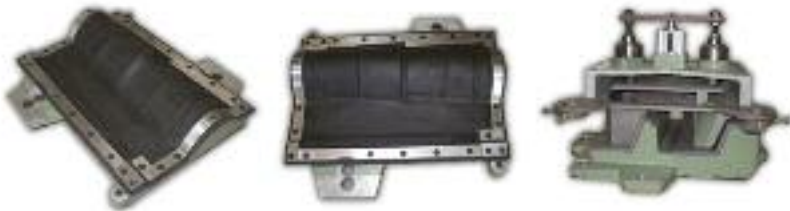
Pressform ausgegossen mit Epoxidharz für Gummituch oder vorgeformte Membran Mould with epoxy resin covering for rubber sheet or preformed membrane
