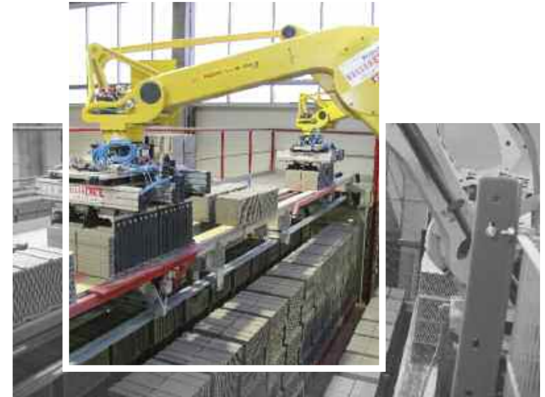
4-Achsen-Industrieroboter zum Setzen des Ofenwagenbesatzes
