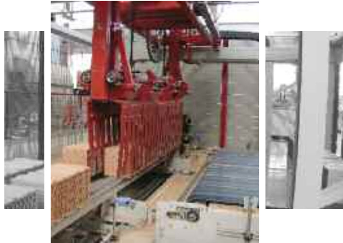
Übersetzer zum Trennen der einlaufenden Ziegelreihen Transfer device to separate the incoming brick rows
