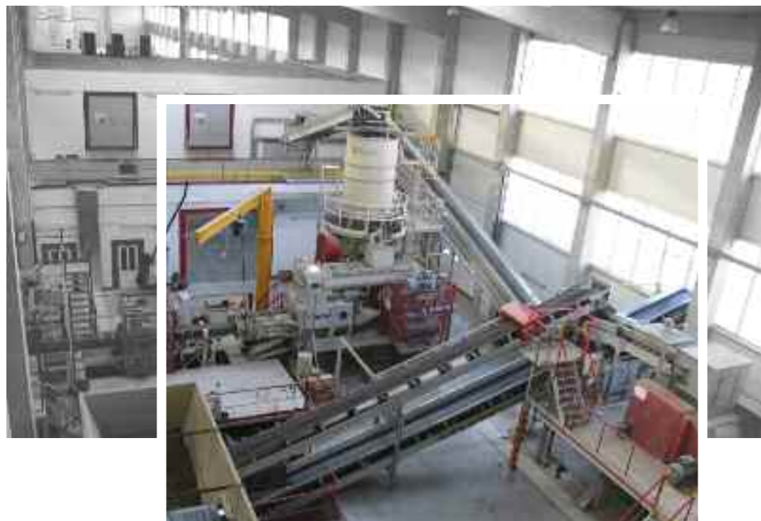
Formgebungsanlage bestehend aus: Kastenbeschicker, Walzwerk, Siebrundbeschicker und Schneckenpresse
