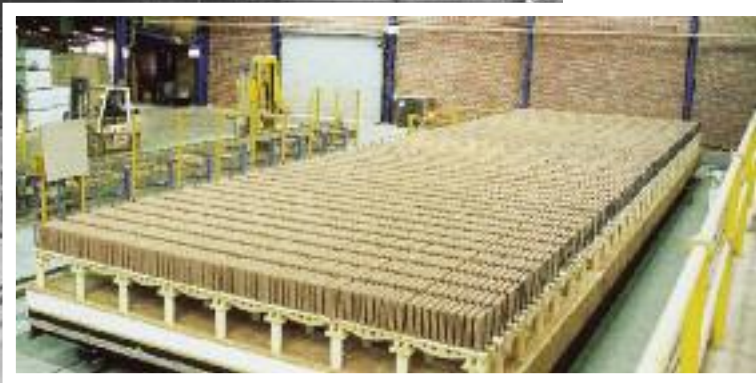
Tunnel kiln car عربة الفرن النفقي
