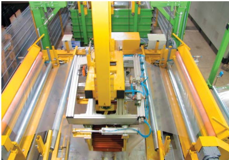
Bild 5: Getauchte Pakete werden durch eine weitere Greifeinrichtung in eine Folienverpackung gesetzt.
