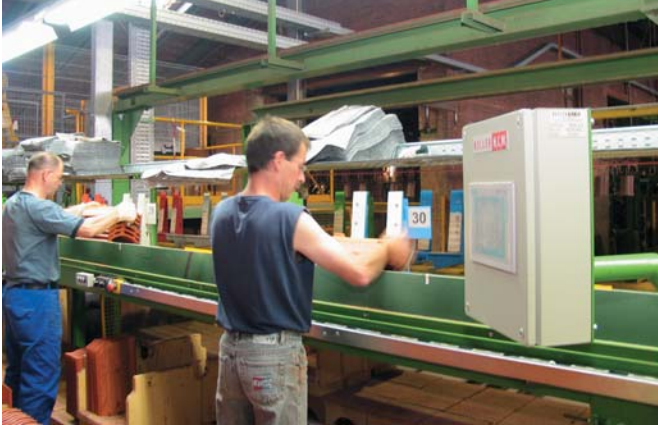
Bild 2: Manuelle Kleinpackchenbildung auf Hilfspaletten Fig. 2: Manual forming of small packs on auxiliary pallets
