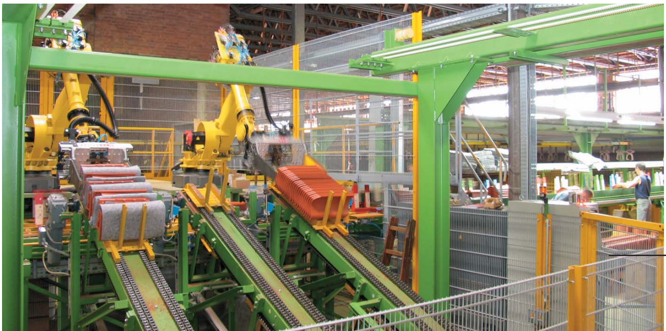
Bild 3: Zwei Roboter nehmen die Kleinpackchen von den Hilfspaletten und bilden in einer schräg angeordneten Sammelbahn sortenreine Paketstangen. Fig. 3: The small packs are removed from the auxiliary pallets by two robots and packs of one size only are formed on an inclined collecting conveyor
