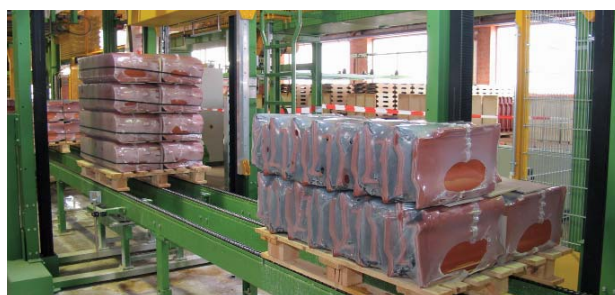
Bild 10: Die fertiggestellten Versandpakete können horizontal und vertikal mit einem Kunststoffband umreift werden. Ebenso besteht die Möglichkeit, das ganze Versandpaket mit einer Folienhaube zu überziehen und die Folie einzuschrumpfen.
