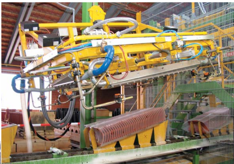
Bild 6: Die um die Paketstange geschlagene Folie wird automatisch verschweißt und geschnitten, sowie in der nächsten Halteposition des Taschenförderers eingeschrumpft.
