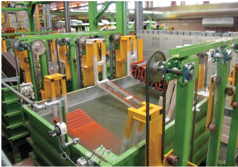
Bild 4: Ein Stangengreifer setzt die Paketstangen zunächst in eine Tauchanlage. Dort können die Paketstangen einzeln in das Tauchbecken abgesenkt werden.
