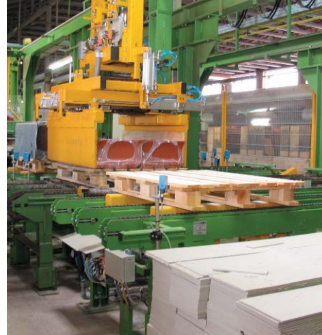
Bild 7/8/9: Im weiteren Ablauf werden die eingeschumpften Paketstangen je nach Format über Zwischenstische zunächst zu Paketlagen verdichtet (Bild 8) oder direkt (Bild 7) auf automatisch zugeführte Paletten gesetzt. Horizontale und vertikale Zwischenlagen werden dabei automatisch eingefügt. Dabei muss weiterhin jedes Produkt in der speicherprogrammierbaren Steuerung verfolgt und der jeweiligen Palettierposition zugeordnet werden (Bild 9).
