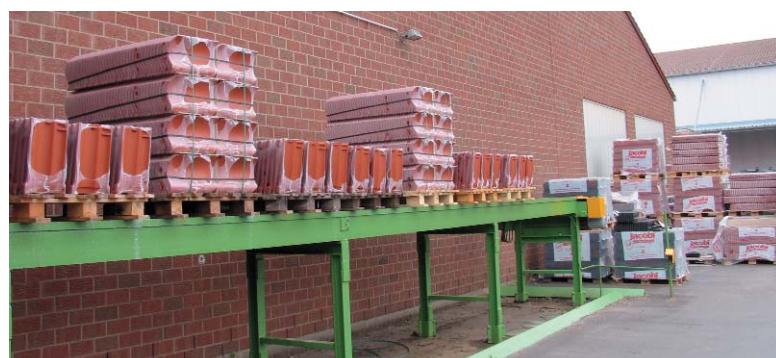
Bild 11: Eine Greifeinrichtung setzt die fertiggestellten Versandpakete auf eine Kettenbahn, über die die Pakete schließlich in das draußen liegende Paketmagazin gelangen. Vom Magazin werden die Pakete mit einem Gabelstapler abgenommen.
