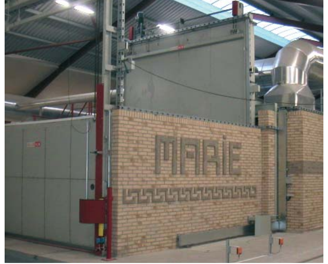
Bild 1: Tunnelofen „Marie“ mit Einfahrtschleuse Fig. 1: Inlet sluice of tunnel kiln „Marie“
