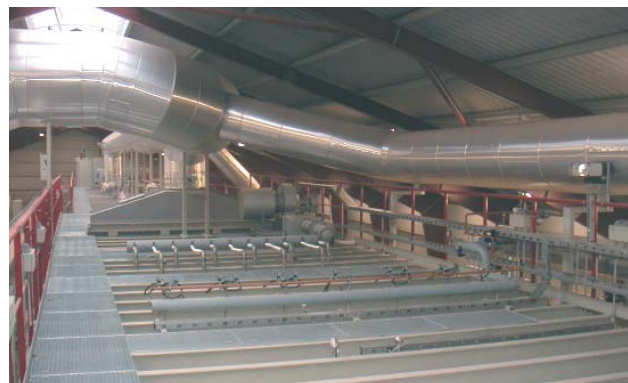
Bild 6: Hochtemperaturabsaugung, Sturzkühlung und Öl-Brennergruppe Fig. 6: High-temperature take-off, rapid cooling and oil burner group
