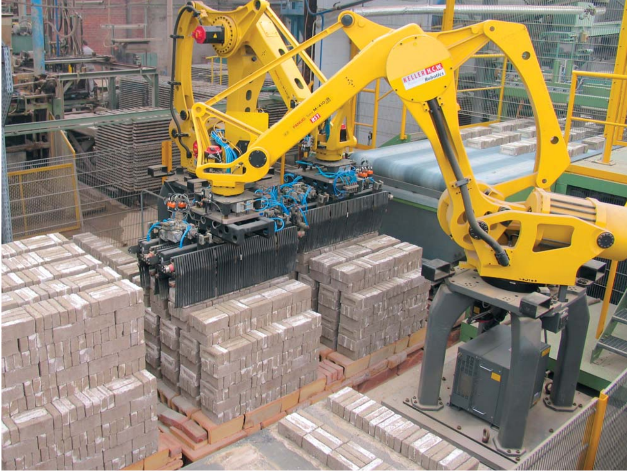
Bild 6: Robotersetzanlage Fig. 6: Robot setting plant
