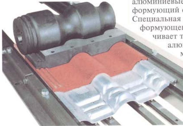
Участок формования: формующий ролик и мундштук. Shaping with moulding roller and die.
