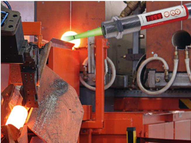
**Bild 2** Aussortierung zu heißer und zu kalter Bolzen
